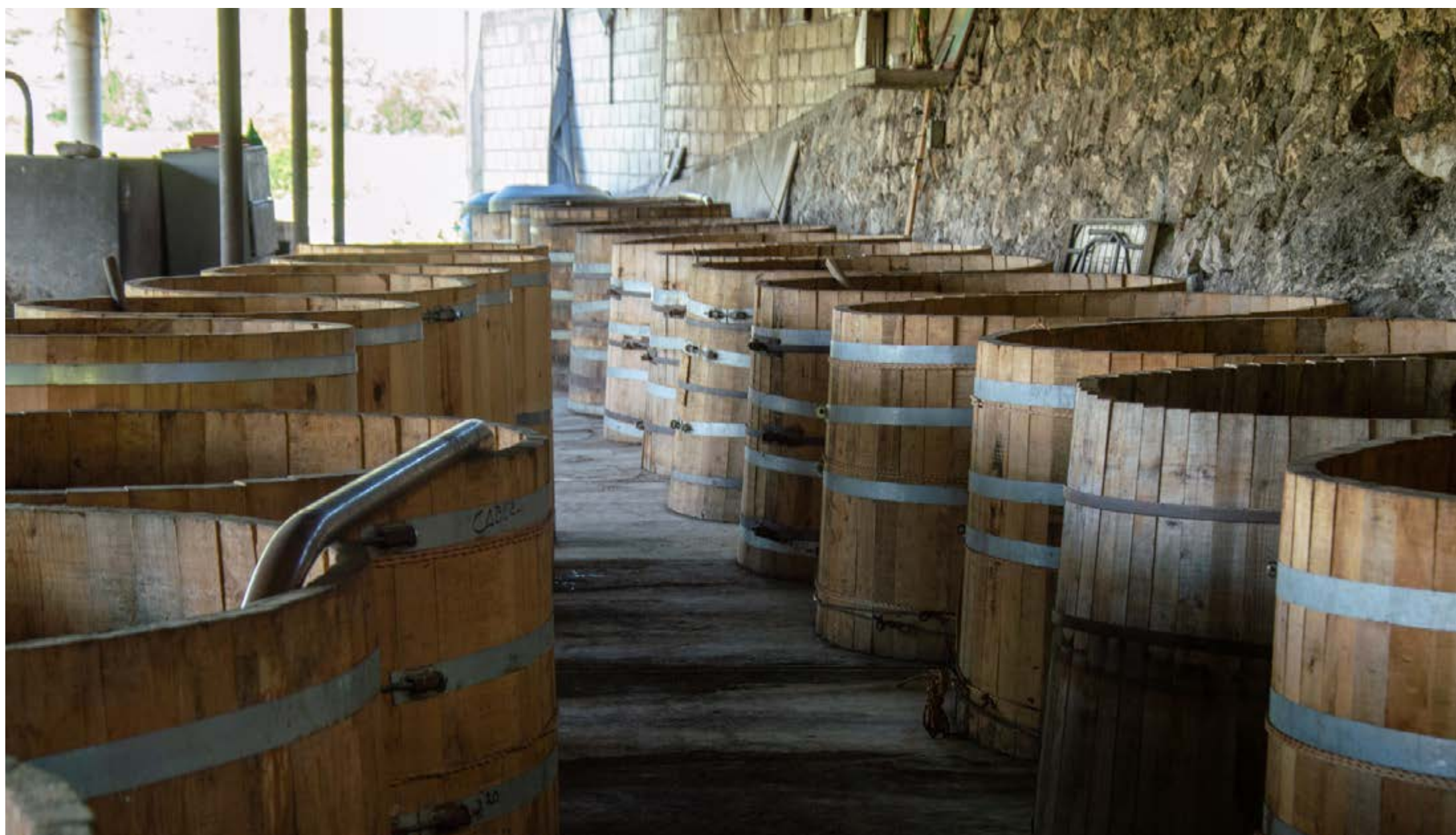
Tinas de Madera para fermentación de mosto en el palenque Tepenahuazo, San Diego la Mesa Tochimiltzingo.
