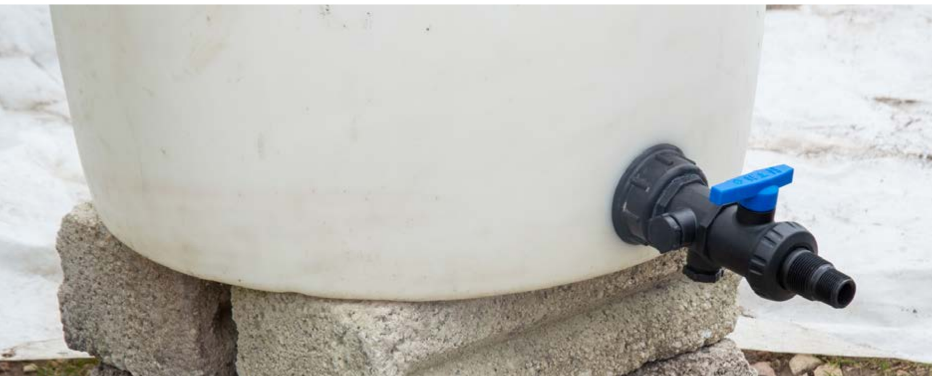
Tambo plástico de 200 litros. Se recomienda con llave de drenaje en la base para las pencas con mayor contenido de líquidos
