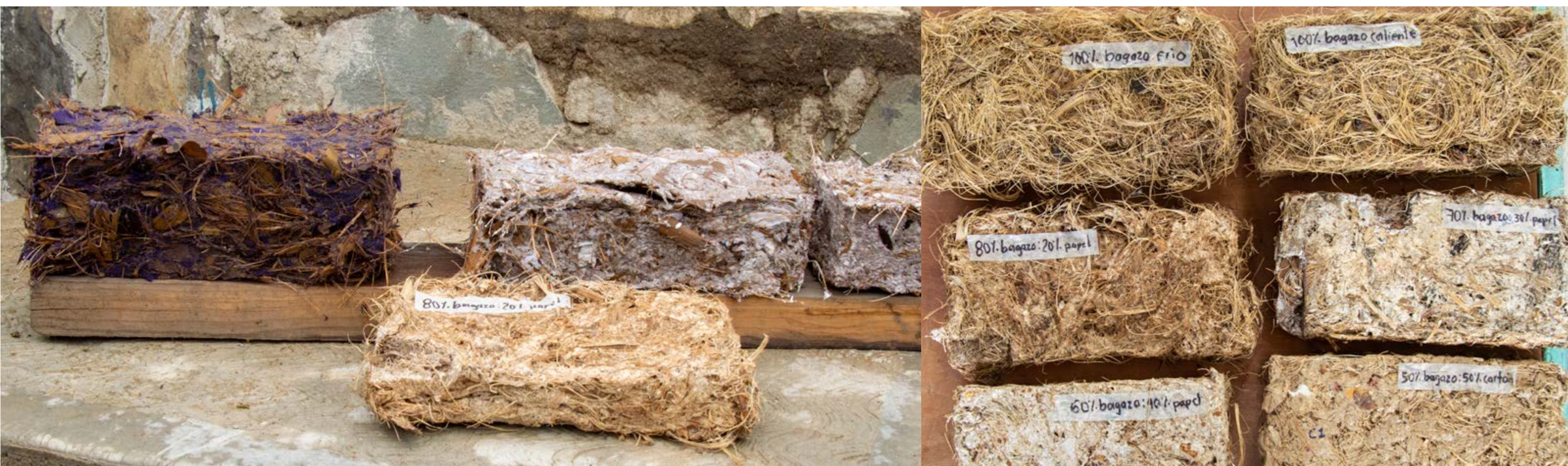
Posterior a ser prensadas las briquetas se ponen a secar al aire libre. Las briquetas pueden contener diferentes tipos de cartón o papel así como diferentes proporciones de bagazo y cartón.
