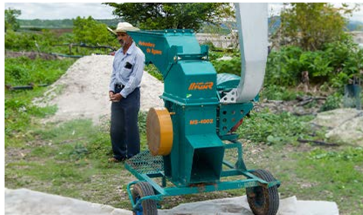
Molino de Martillos o Hebradora de Agave.
